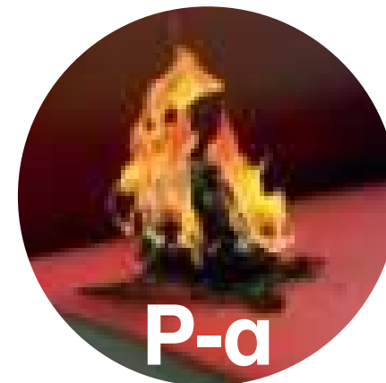
Papierkissentest nach DIN 54341 Paper pillow test as per DIN 54341
