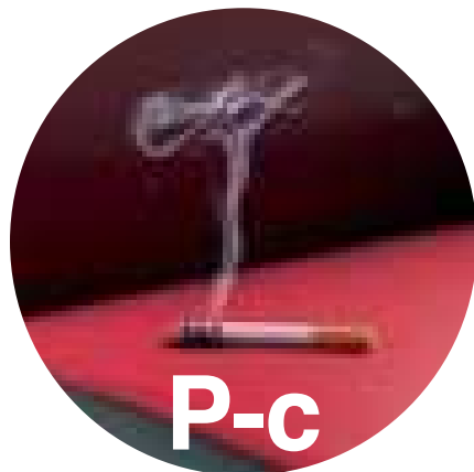
Zigarettestest nach DIN EN 1021 Teil 1 Cigarette test as per DIN EN 1021 Part 1
